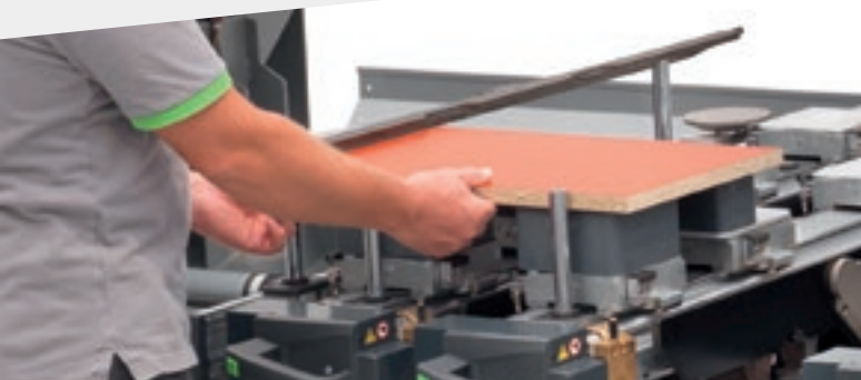
Sistemi di bloccaggio tramite vuoto .
