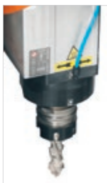
Motore verticale fisso dedicato a la- vorazioni accessorie di fresatura (slot, an- tischeggiatura, ...).
