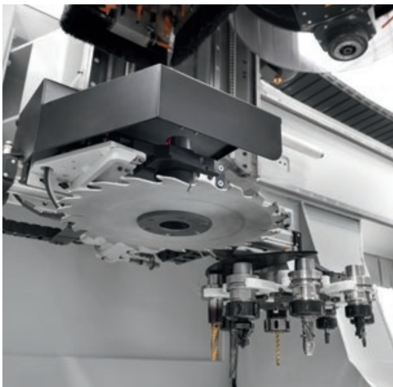
Magazzino a singolo posto e magazzino a revolver 8 posizioni
