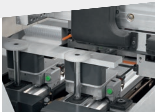
Sistema di bloccaggio Easyclamp per lavorazioni di pezzi stretti.
